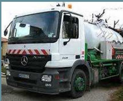
La vidange est obligatoire et nécessaire pour éviter tout engorgement des tuyaux (d'entrée et sortie de fosse) et des drains (épandage élément épurateur). Les vidanges doivent se faire par une entreprise spécialisée, agréée par la préfecture ou par le SPANC (service public d'assainissement non collectif), dans certains cas. Les vidanges doivent avoir lieu **Pour les fosses septiques : tous les 4 ans** **Pour les fosses toutes eaux : tous les 2 à 3 ans**
